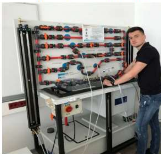
Mjerenje na fizikalnom modelu - završni rad iz kolegija Hidromehanika pod nazivom „Fizikalni model određivanja lokalnih i linijskih gubitaka u cijevnom sustavu pod tlakom“, 2017.
