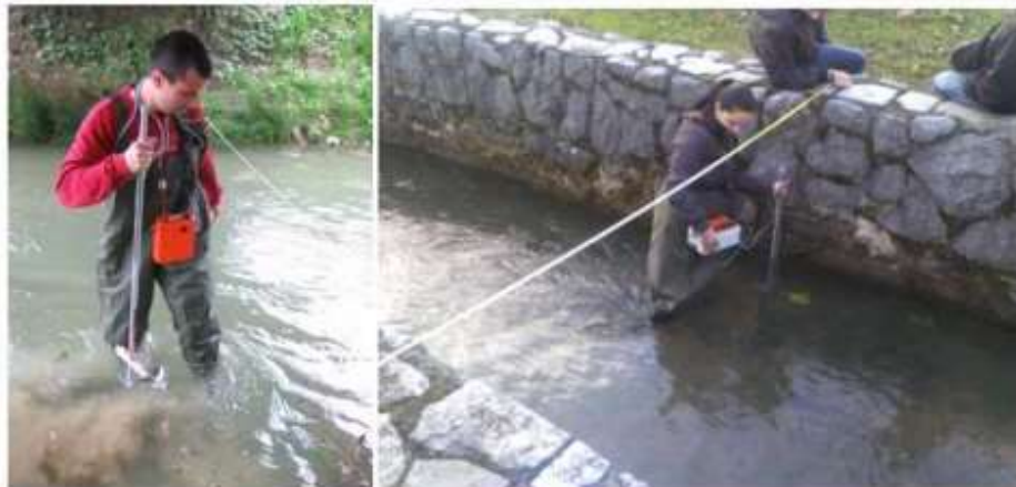
Mjerenja protoke hidrometrijskim krilom na Rakovom potoku u slivu Pazinčice (2005) i na potoku Mlaka u Rijeci (06.12.2012.)
